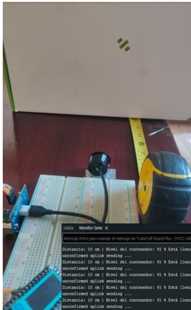
Figura 62 Resultado de simulaci3n de un contenedor lleno
