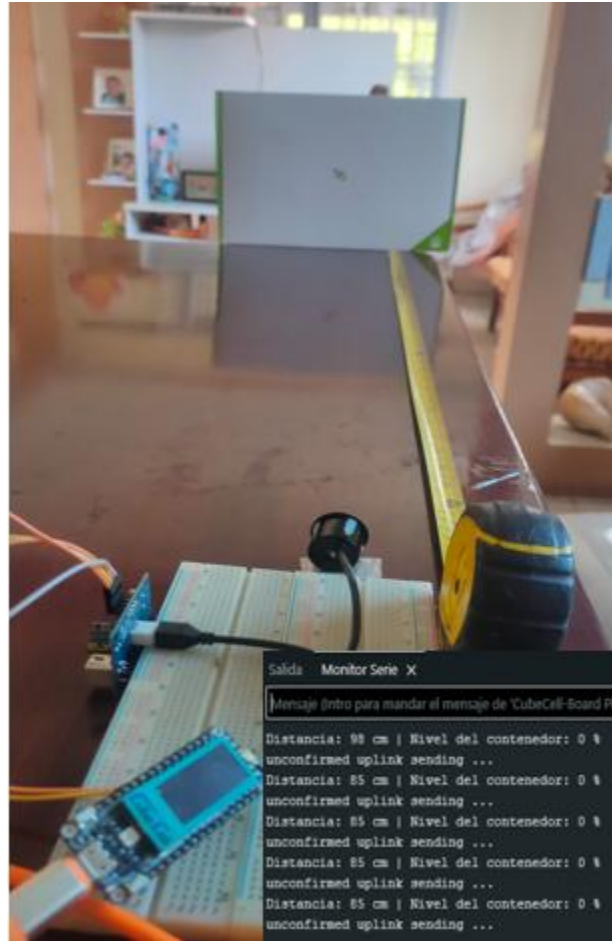
Figura 61 Resultado de simulación de un contenedor vacío de 1 m
