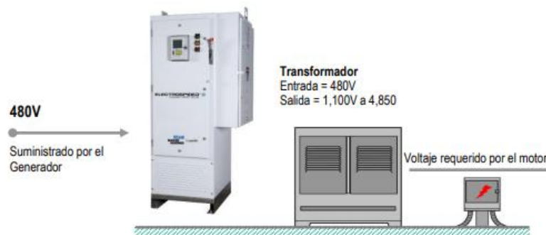
Figura 9. Transformadores. Fuente. (Baker Hughes, 2019)
