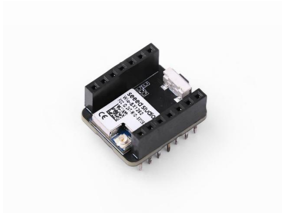
Figura 6 Módulo wio-sx1262. Adaptada de [186]
