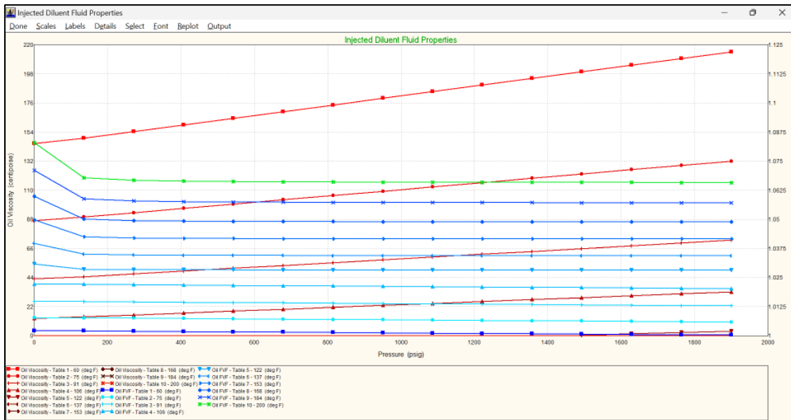
Figura 25 Comportamiento del diluyente en la viscosidad del pozo 2. (PROSPER,2025)
