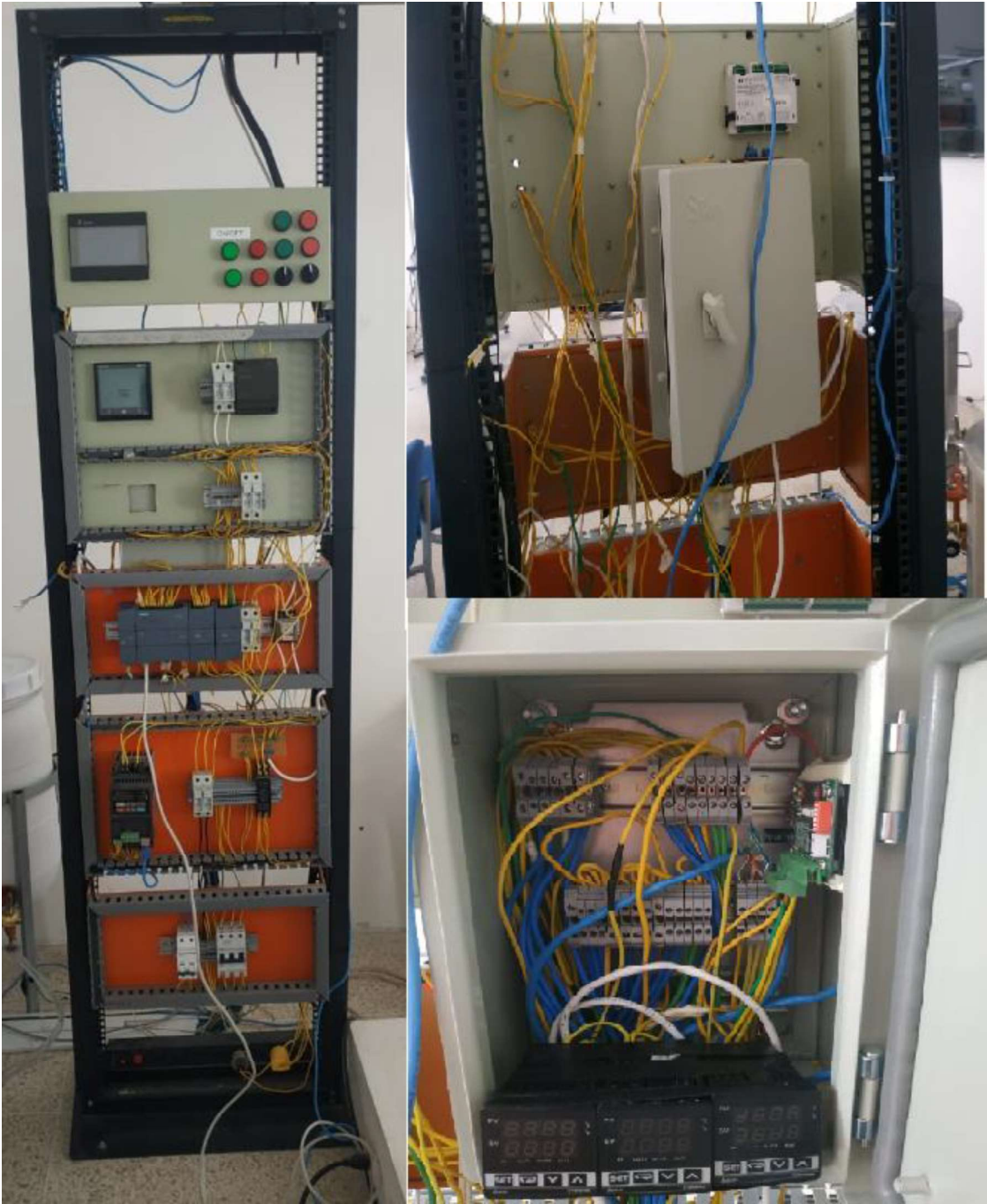
Anexo 10: Panel de control del sistema.
