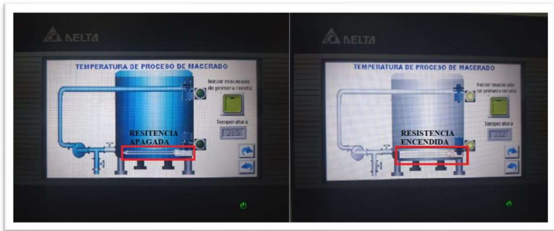
Figura 82. HMI resistencia eléctrica apagada y encendida.
