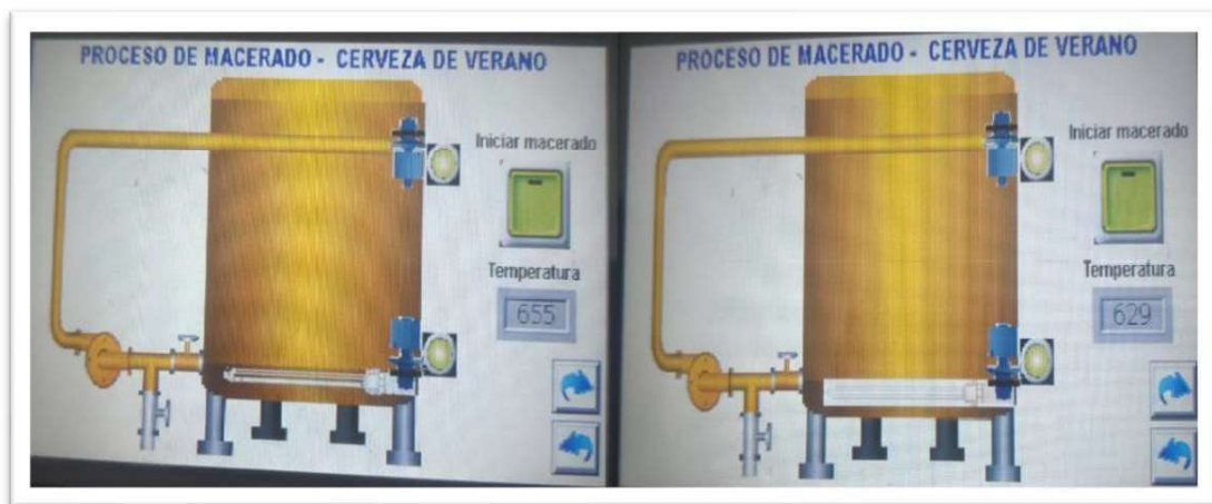
Figura 77. Control de la resistencia eléctrica mediante la temperatura.
