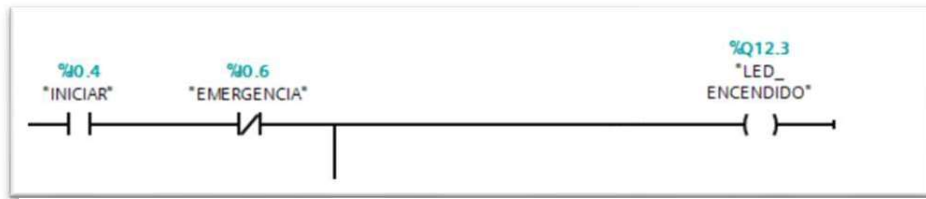
Figura 48. Encendido y emergencia del sistema.
