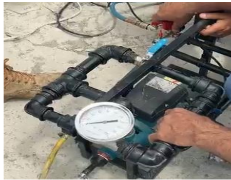
Figura 29: Proceso de mezcla aire–espumante en el generador.
