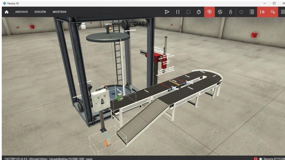
Figura 23: Diseño de la planta de embotellamiento en el entorno de simulación Factory I/O. Fuente: Elaboración propia.
