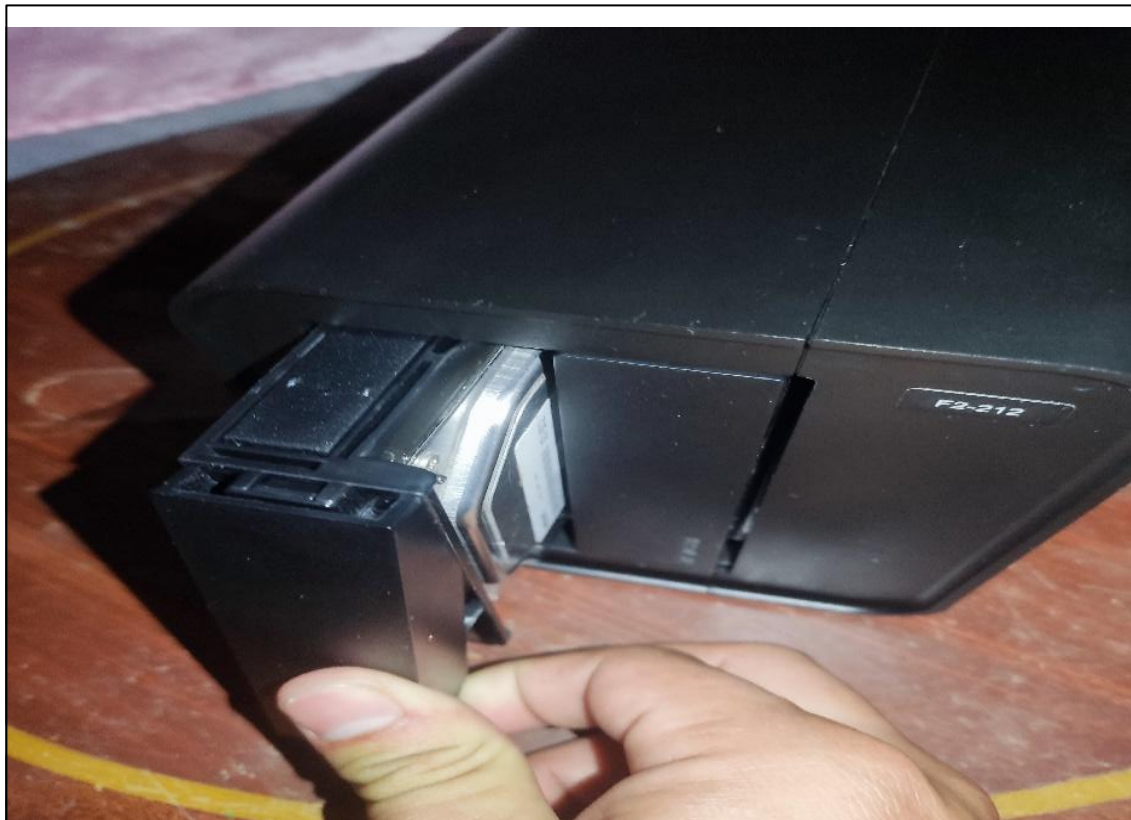
FIGURE 9 INSTALACIÓN DE DISCO DUROS AL NAS
