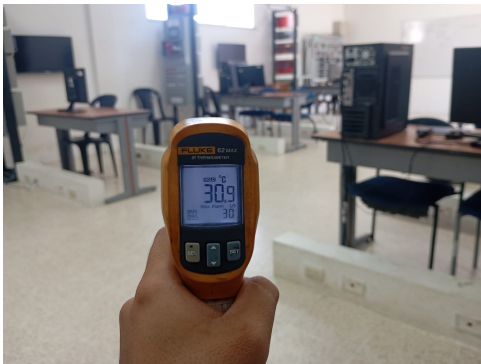
Figura 33: Valor del pírometro en un ambiente controlado
