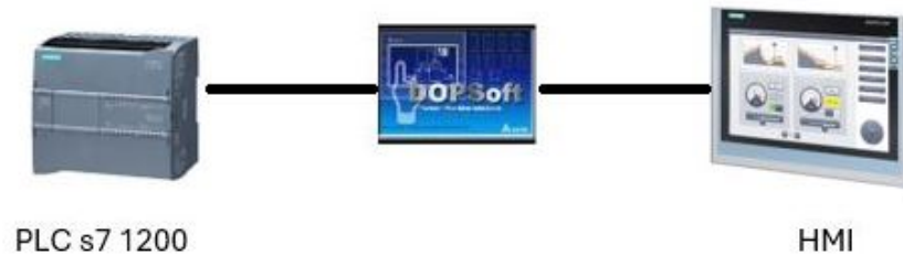
Figura 14: Comunicación entre el HMI Y PLC
