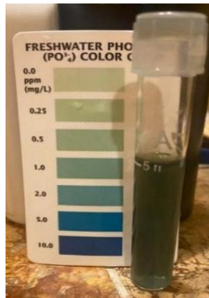
Figura 8: tabla colores del kit de colimetría del fosfato.
