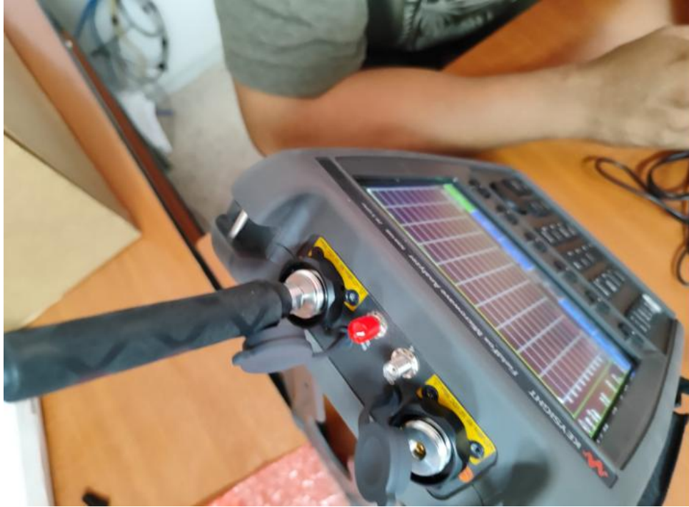
Figura 34 - Revisión y confirmación de instalación de puertos SMA
