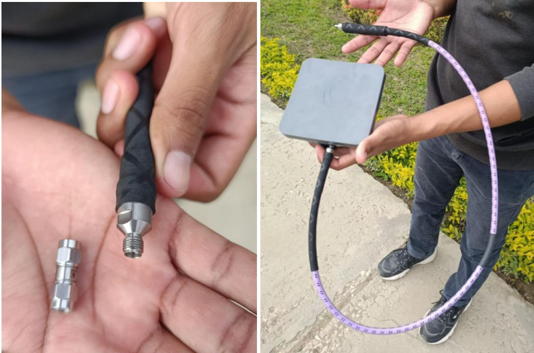
Figura 36 - Antena LTE, Adaptador para el puerto de la VNA y cable Coaxial
