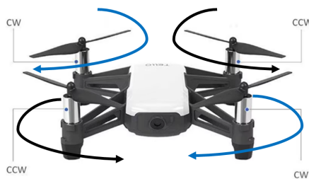
Figura 37: Sentido de giro de motores.
