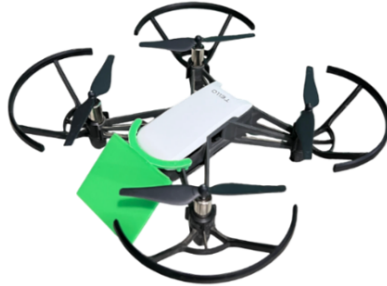
Figura 49: Soporte acoplado al dron. Fuente: Autoría propia
