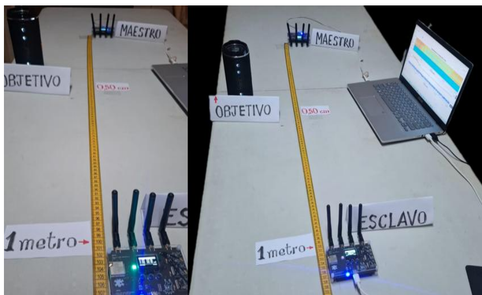
Figura 23. Montaje experimental: separación total de 1 m entre los RF-Clown.
