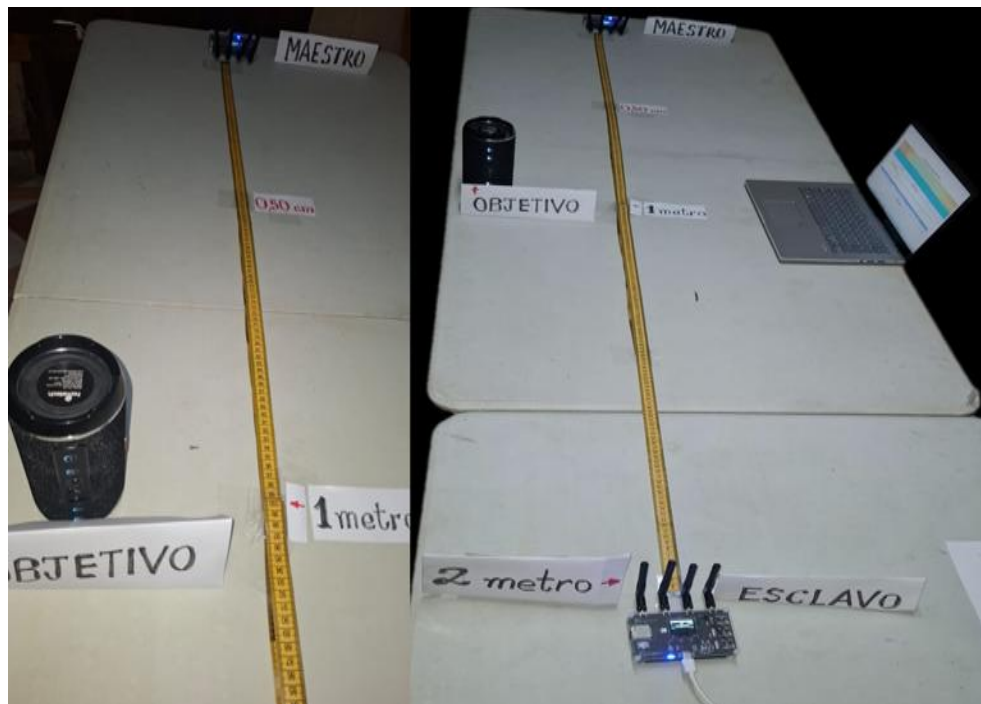
Figura 24. Montaje experimental: separación total de 2 m entre los RF-Clown.
