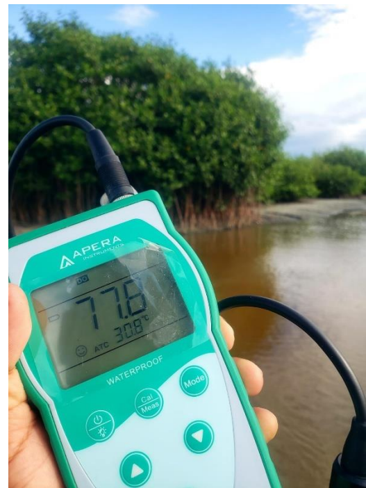
Ilustración 5. Equipo APERA para medir oxígeno.
