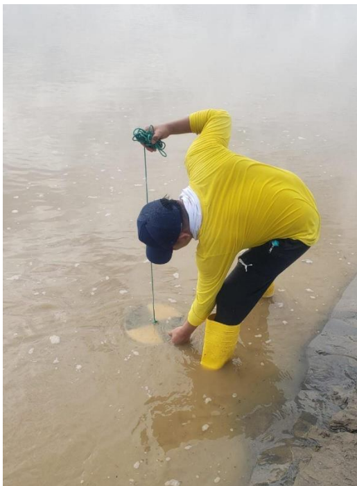
Ilustración 4. Medición de turbidez.
