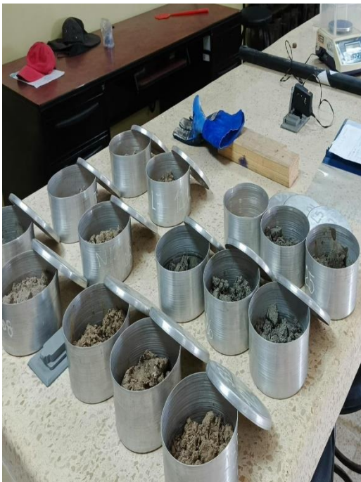
Ilustración 12. Secado de muestras para el análisis Granulométrico.
