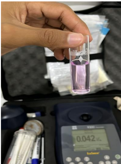
Ilustración 8. Análisis por fotometría niveles bajos de nitritos.
