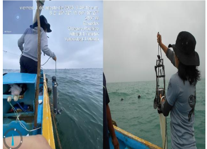
Figura 97 Toma de muestra de agua mediante botella Niskin. Arrastre vertical estratificado superficial para fitoplancton con red Clarke bumpus.
