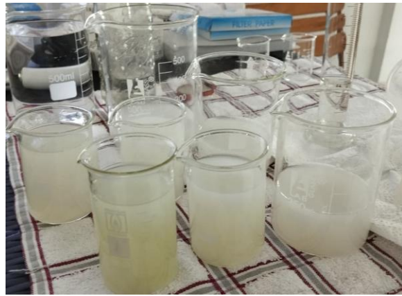
Anexo 5. Preparación de Alginato:Microalga con las tres distintas proporciones
