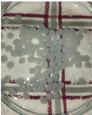
Anexo 6. Formación de perlas de alginato al reaccionar con el cloruro de calcio
