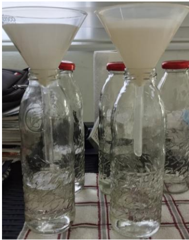
Anexo 4. Filtración del agua residual en las botellas.
