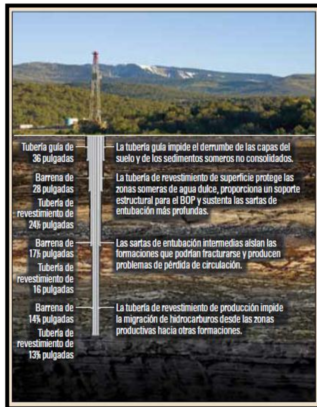
Fig. # 36 Perfil del pozo. Para perforar un pozo, se utiliza barrenas y sartas de entubación de diámetro cada vez más pequeño, lo que genera un perfil telescópico.
