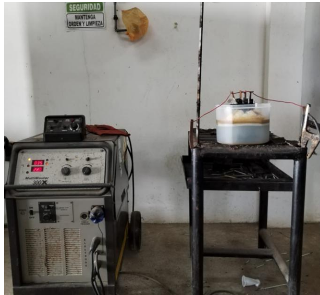
Figura 14. Proceso de Electrocoagulación. Fuente: (Alegría Soriano, 2024).
