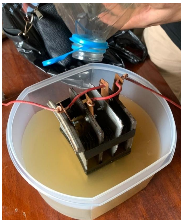
Figura 22. Celda Electrolítica. con muestra de agua.
