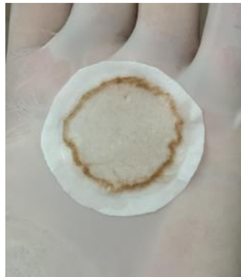
Anexo 10. Filtro de membrana con sólidos suspendidos del Bioensayo 2.
