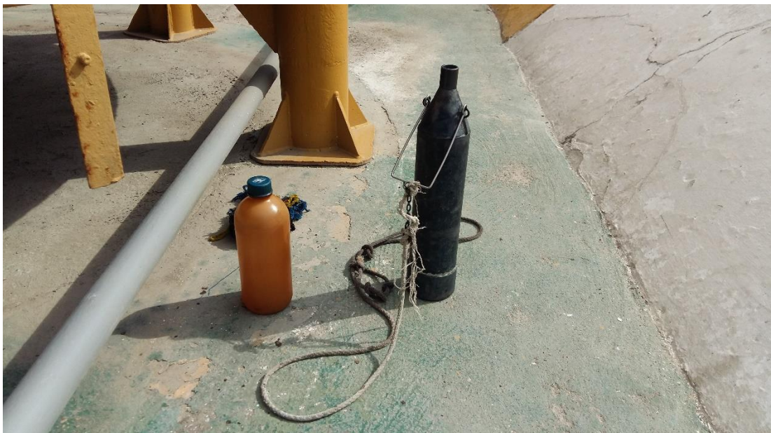
Figura N° 38 Ladrón equipo utilizado para obtener una muestra GB.
