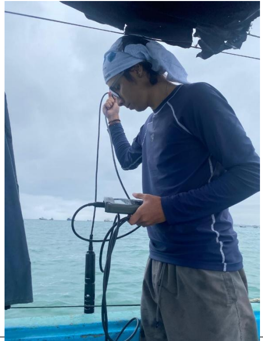
Anexo 5. Correcto manejo de la toma de parámetros con Multiparámetro.
