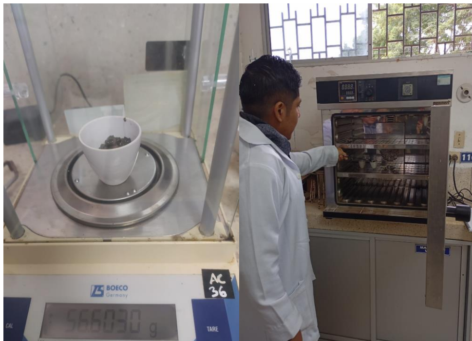
Anexo 16. Prueba de materia orgánica por el método LOI o pérdida por ignición.
