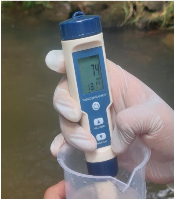
Fotografía 9. Toma de los valores de los SDT in situ .
