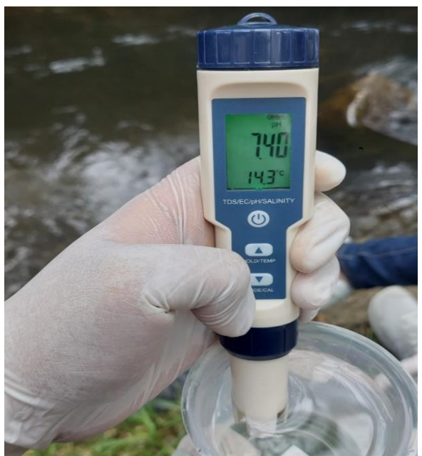
Fotografía 8. Toma de los valores de pH y temperatura in situ .
