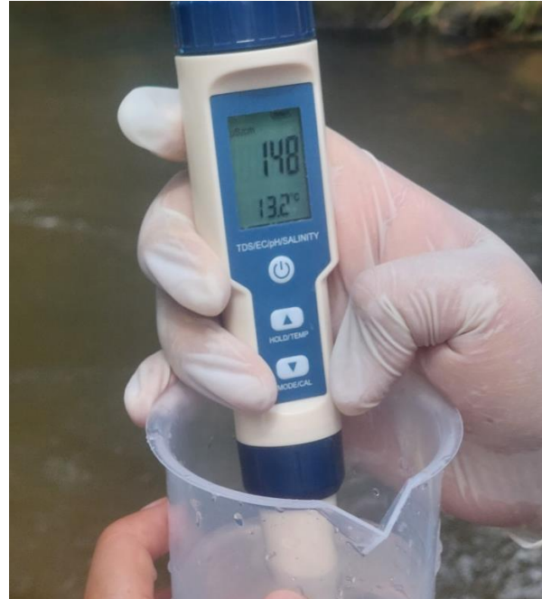
Fotografía 10. Toma de los valores de la CE in situ .
