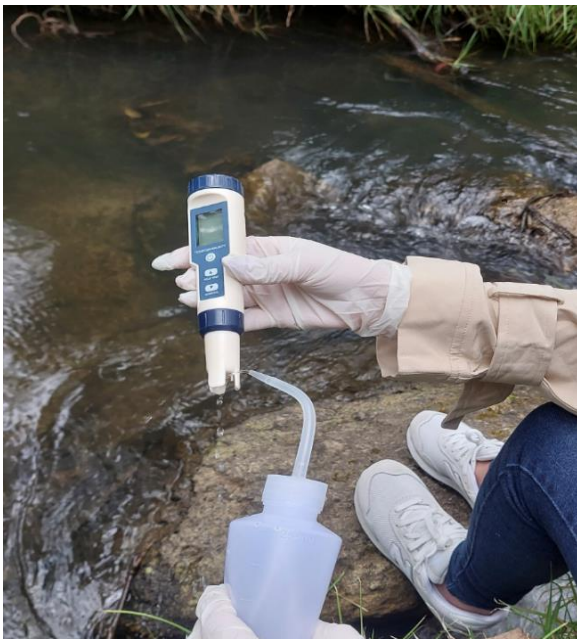
Fotografía 7. Limpieza del electrodo/esfera del sensor del multiparámetro para toma de mediciones.
