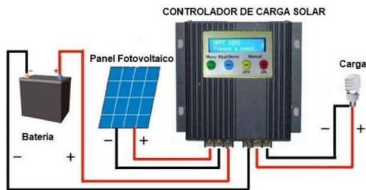
Figura 8. Controlador de carga solar Fuente: (Tumbaco, 2023)
