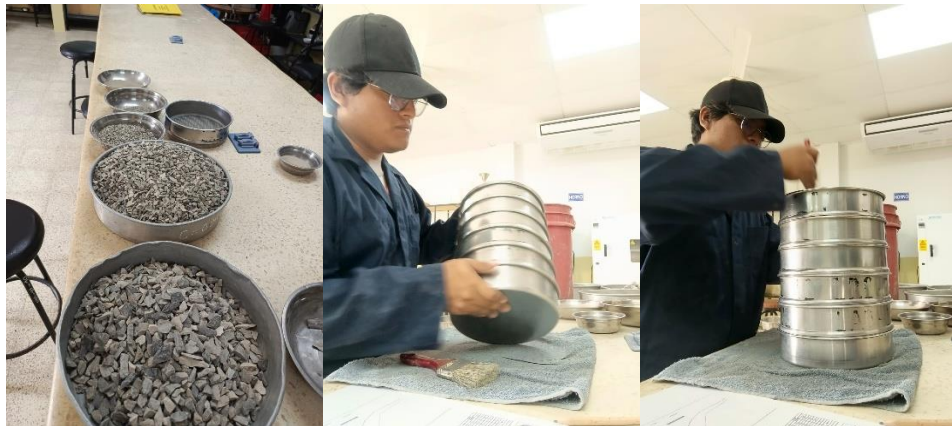
Fracciones Retenidas de los agregados (Grava \frac{3}{4} ", Arena, Cisco \frac{3}{8} ") en cada Tamiz
