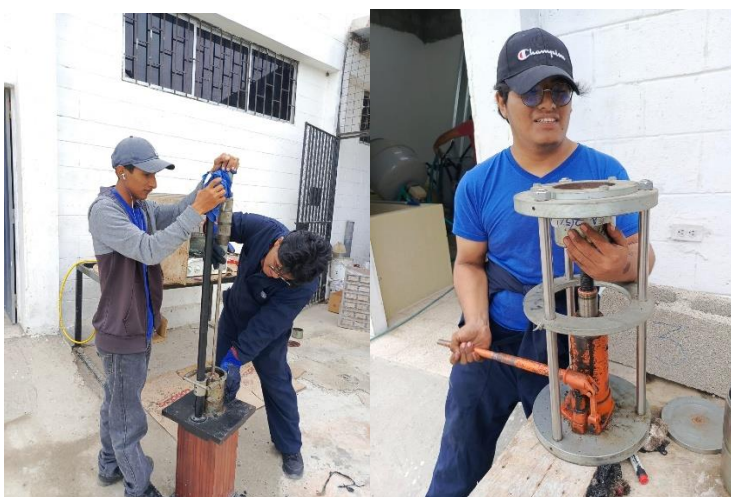
Elaboración y extracción de las briquetas
