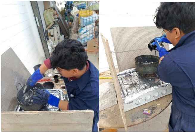
Adición de Asfalto y mezclado con los porcentajes de asfalto
