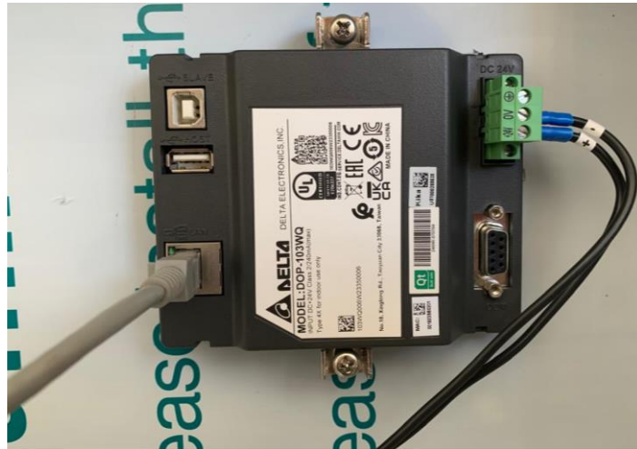
Figura 43. Conexión del HMI Delta DOP-103WQ. Fuente: Autoría propia.
