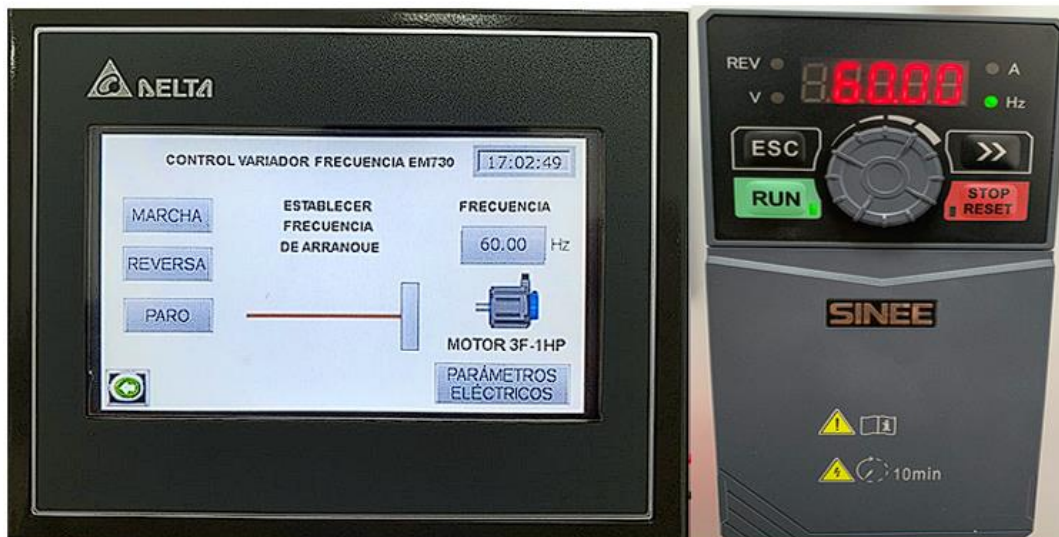
Figura 93. Monitoreo y control del motor trifásico de forma física a través del HMI-DOP103WQ y el variador SINEE EM730. Fuente: Autoría propia.
