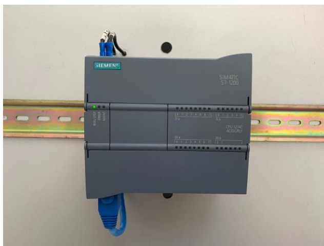
Figura 42. Conexión del PLC S7-1200. Fuente: Autoría propia.
