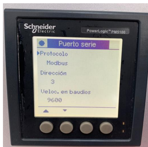
Figura 38. Configuración del puerto serie del medidor de parámetros PM5110. Fuente: Autoría propia.
