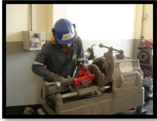
Imagen 3.3. Roscado de tubería
