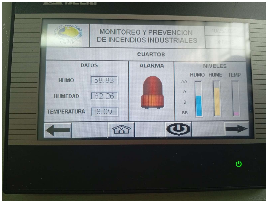
Figura 35: Visualización del área de Cuartos en el HMI
