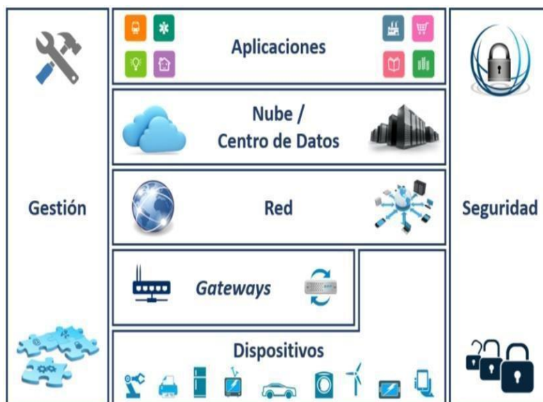
Figura 2 Arquitectura del Sistema IoT (Benitez & Anías, 2016)
