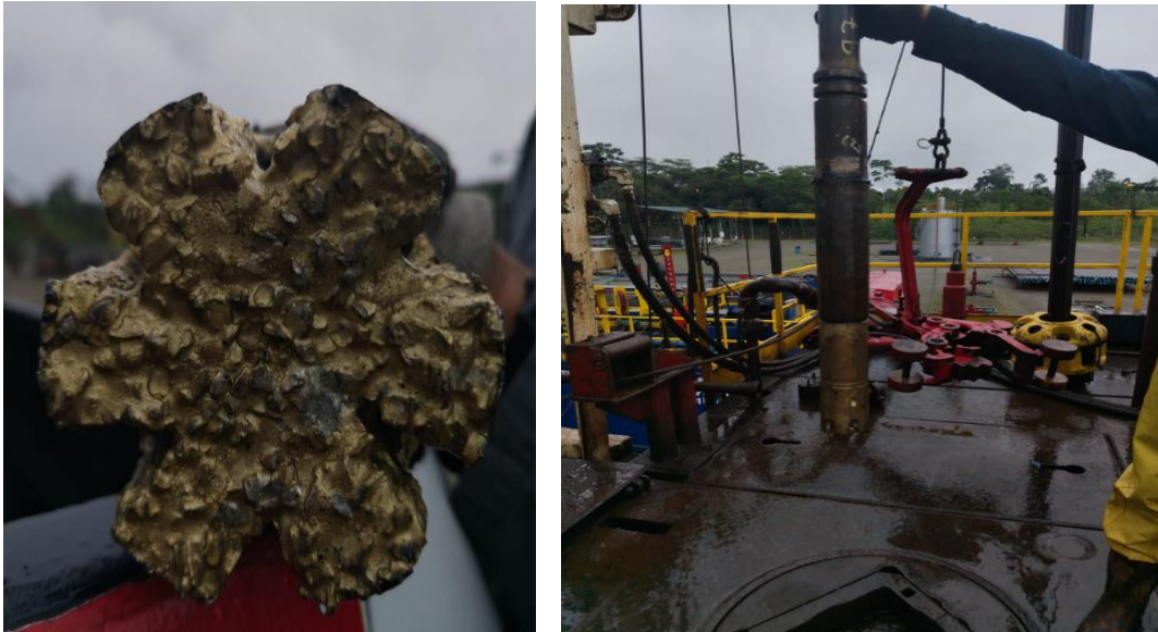
Ilustración 5. Armado BHA moledor con Junk mill para molienda de escala con Torre de Reacondicionamiento pozo SHSI-119
