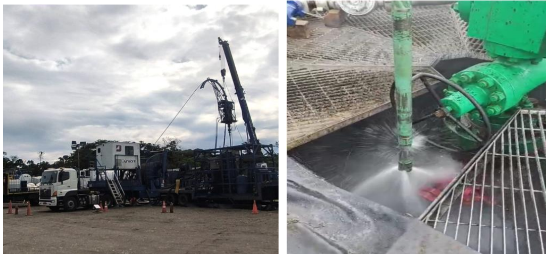
Ilustración 4. Unidad de Coiled Tubing y BHA de molienda con junk mill y motor de fondo para limpieza de tuberías de superficie y fondo de pozo Rigless
