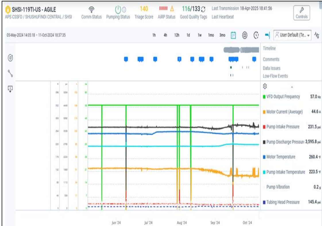
Ilustración 22. Parámetros de funcionamiento BES periodo Junio a Octubre de 2024 antes de iniciar el Reacondicionamiento #14
