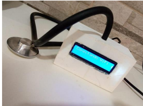
Figura 21: Dispositivo IoT basado en ESP32 para captura de sonidos respiratorios.
