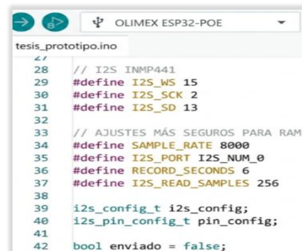
Figura 20: Configuración de pines I2S y parámetros de captura del ESP32.
