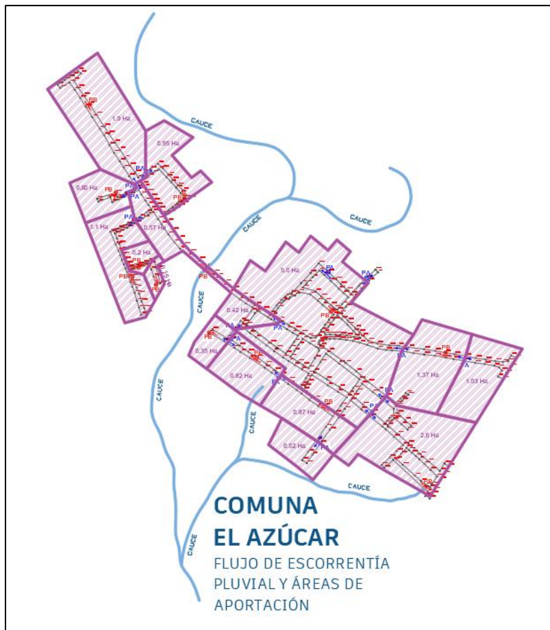
Imagen 7. Trazado de áreas de aportación con el área correspondiente de cada una
