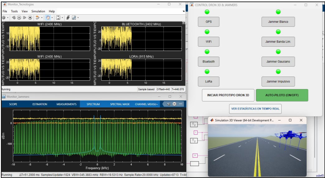
Figura 62. Todos los jammers activos frente a tecnologías integradas
