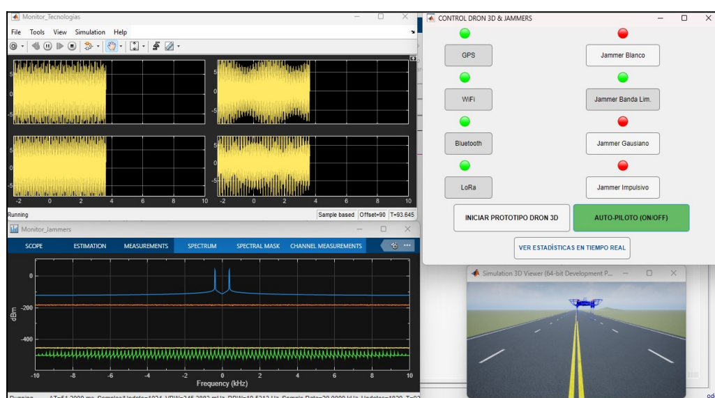
Figura 65. Jammer de banda limitada y tecnologías del dron
