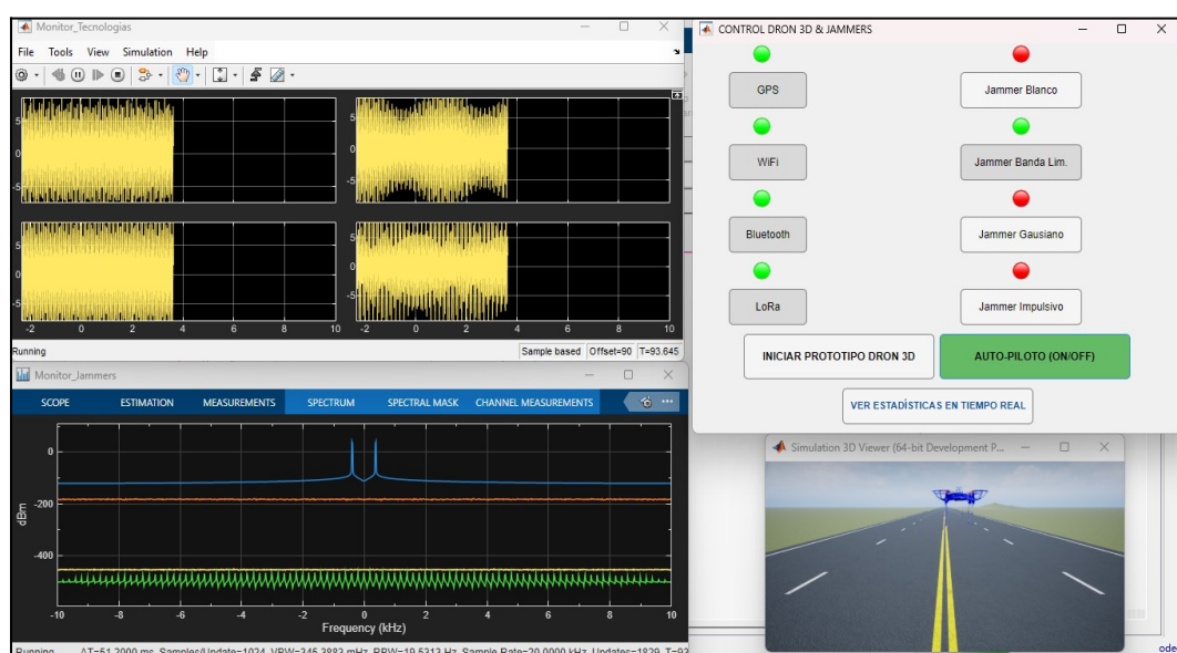
Figura 59. Jammer de banda limitada frente a tecnologías integradas
