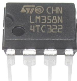
Figura 8: Amplificador operacional LM358.
