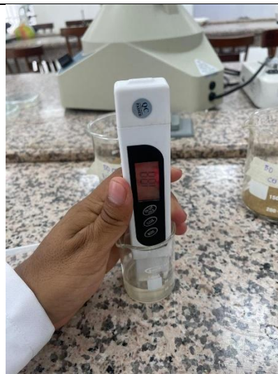
Anexo A 6 Medición de conductividad eléctrica
