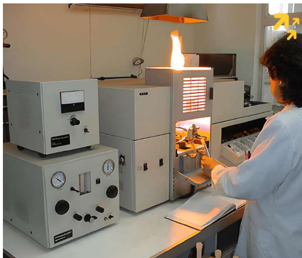
Figura 19. Aplicación de la espectrofotometría de absorción atómica en análisis químico.
