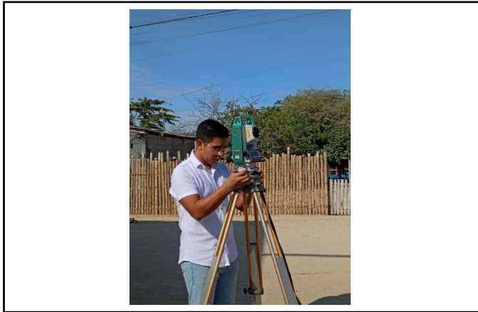
Anexo E: Calado de la Estación Total – realización del Levantamiento Topográfico
