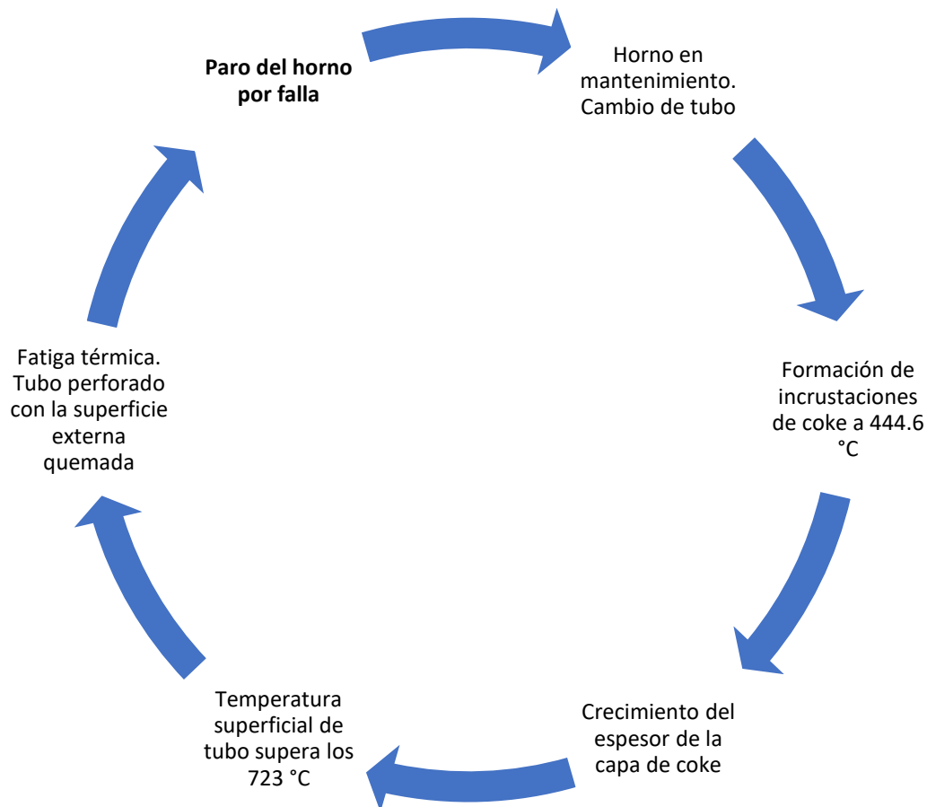
Figura 3. Formación de coque en las tuberías.
