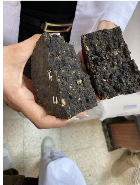
Briqueta de emulsión asfáltica después de ensayo TSR -UPSE
