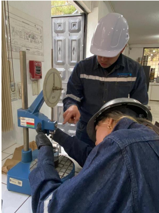
Ensayo de penetración a estabilizadores asfálticos - EMULDEC
