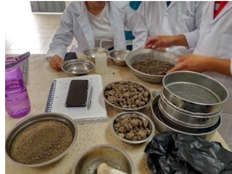
Ensayo de granulometría vía húmeda - UPSE
