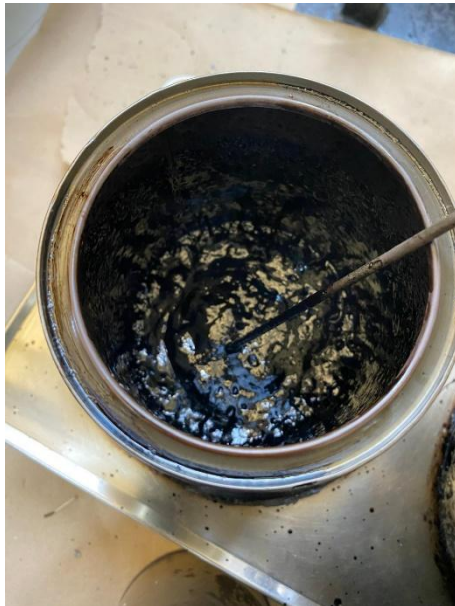
Ensayo de residuos de asfalto - EMULDEC
