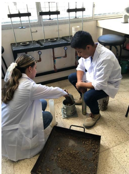
Ensayo Proctor modificado - UPSE
