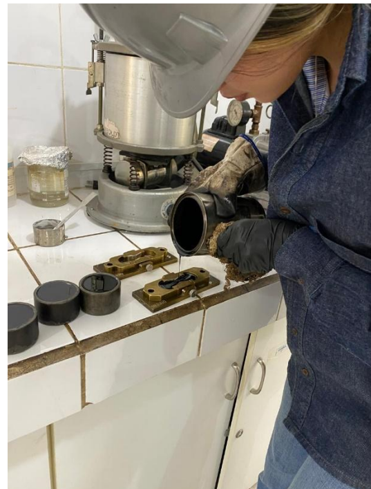
Preparación de muestra para ensayo de ductilidad - EMULDEC
