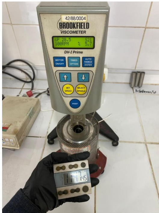
Ensayo de viscosidad Brookfield - EMULDEC
