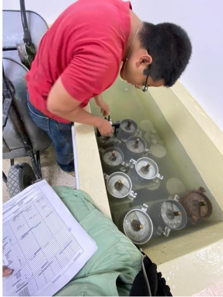
Toma de lecturas de hinchamiento de muestras sumergidas CBR - UPSE
