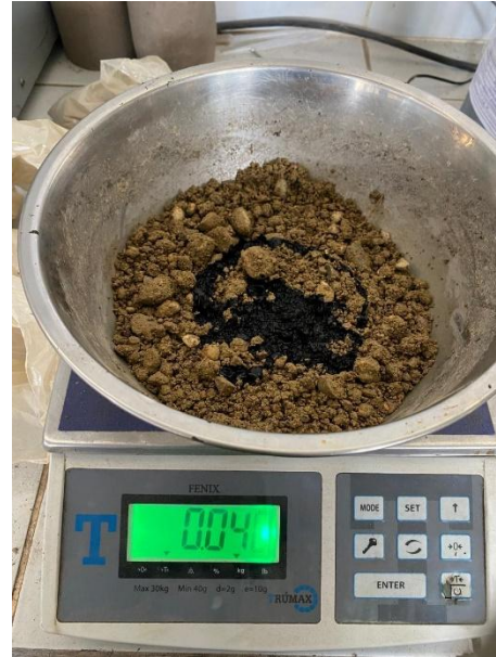
Dosificación de emulsión asfáltica en suelo previamente humedecido - EMULDEC
