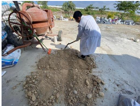
Cuarteo y preparación de la muestra - UPSE
