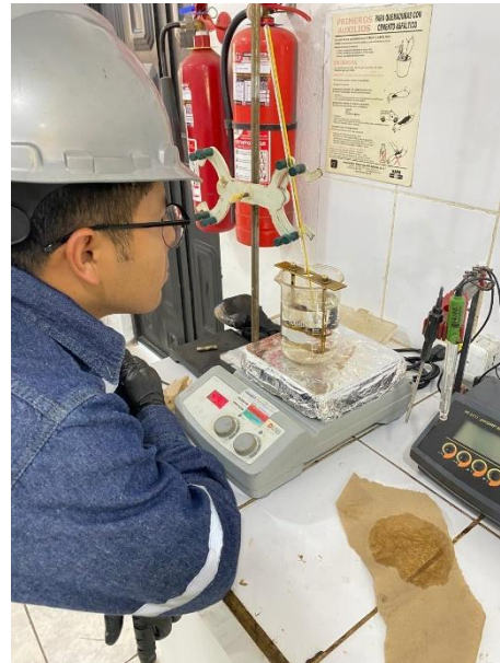
Ensayo de punto de reblandecimiento - EMULDEC
