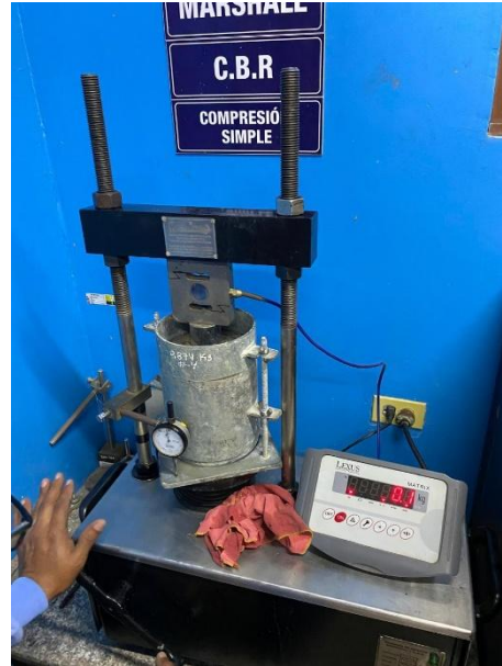
Ensayo de penetración CBR - UPSE
