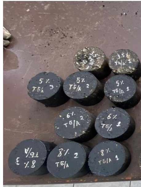
Briquetas con asfalto diluido después del curado - EMULDEC
