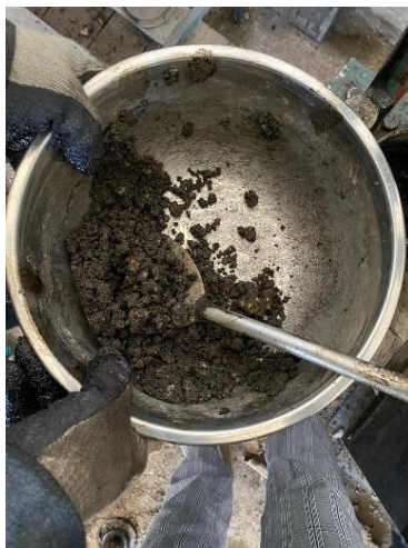
Figura 3.5 Mezcla de emulsión asfáltica con material granular
