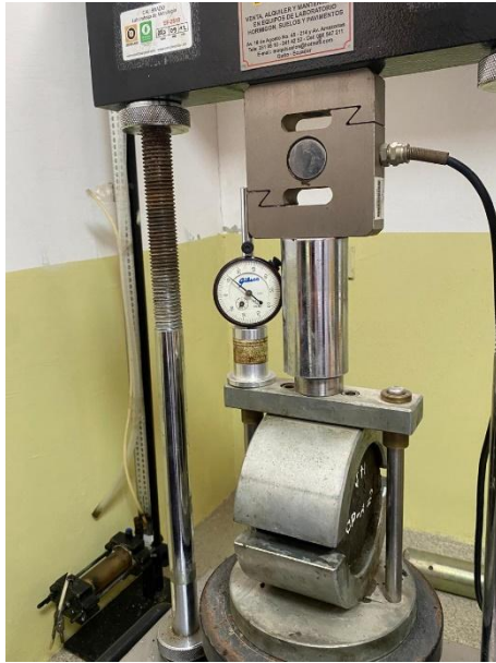
Rotura Marshall a briquetas con estabilizante óptimo - UPSE
