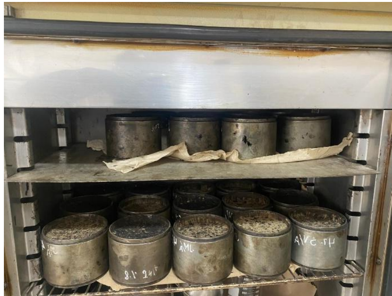
Figura 3.6 Curado en horno a 60°C por 48 horas
