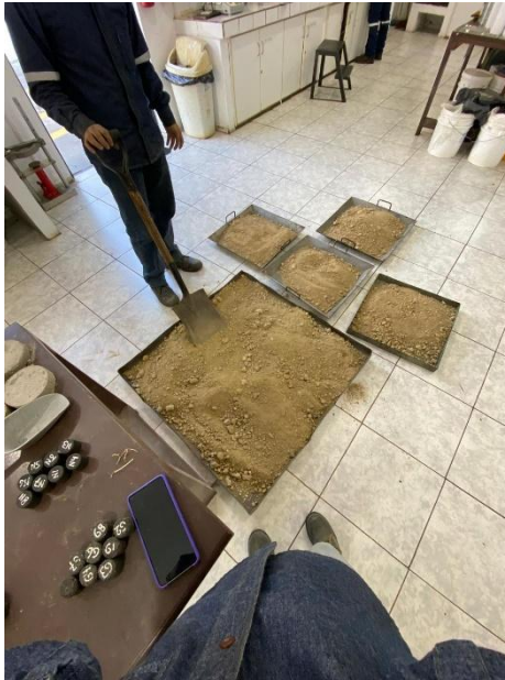
Preparación y tamizado de suelos - EMULDEC
