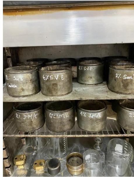
Curado de briquetas en horno a 60°C - EMULDEC
