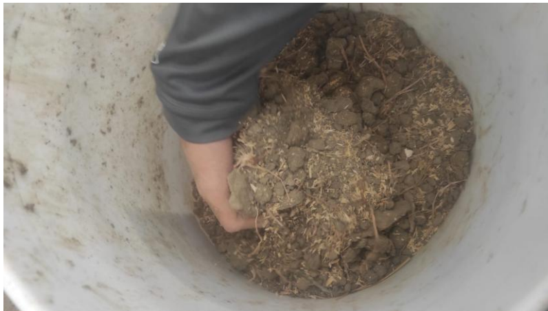
Figura 14A. Incorporación de la cascarilla de arroz en el suelo convencional en proporción 1:1 para el tratamiento SCCA
