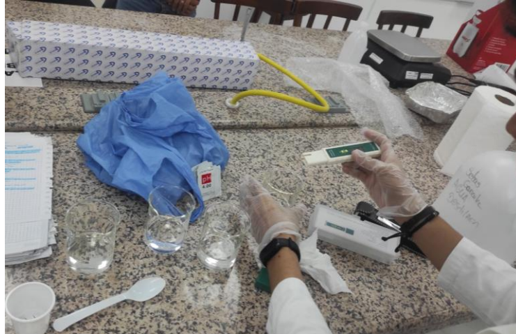
Figura 9A. Calibración del potenciómetro con la norma estándar a tres puntas
