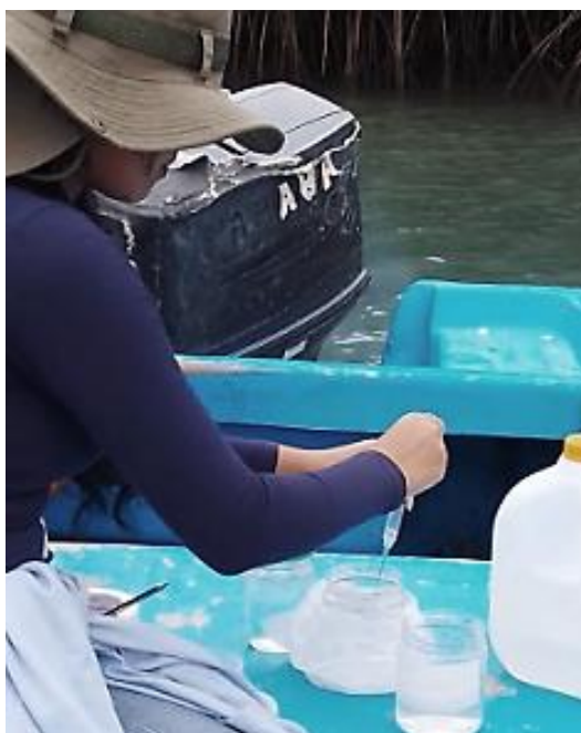
Anexos 19. Se adiciona formaldehído al 4% tamponado con bórax a la muestra.
