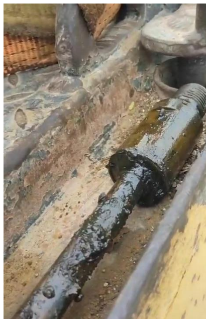
Figura. 16 Varillas de bombeo mecánico con parafina y escala
