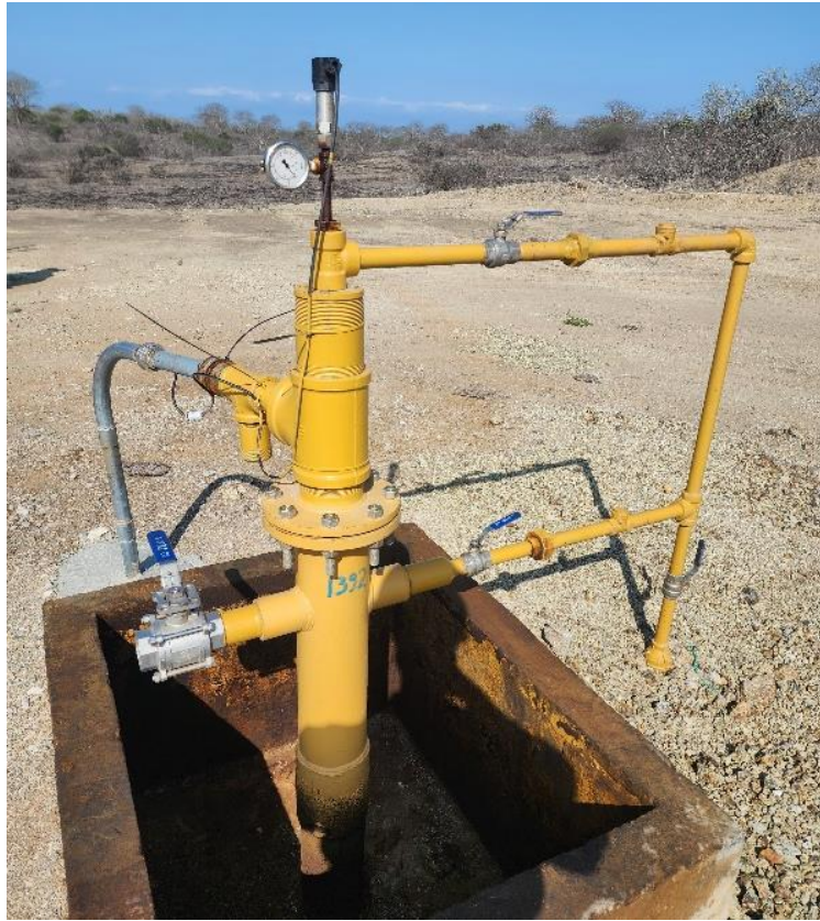
Figura. 6. Bombeo de cavidades progresivas (BCPE)
