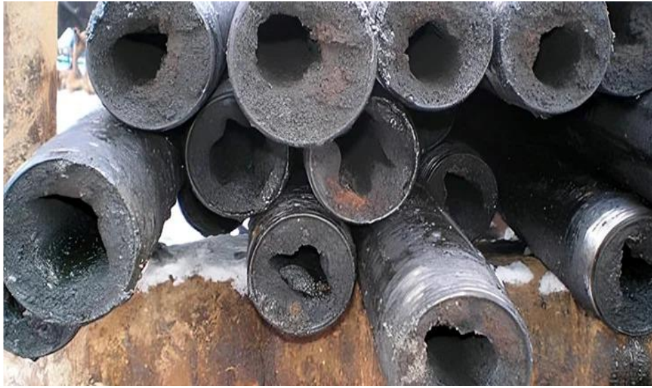
Figura. 7 Formación de parafinas en las tuberías
