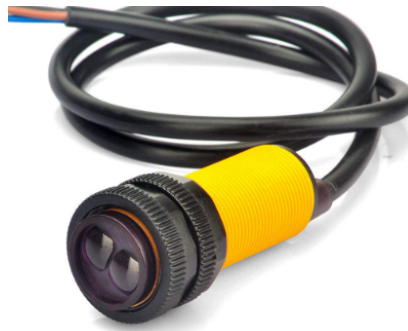
Figura 18: Sensor infrarrojo E18-D80NK [12].
