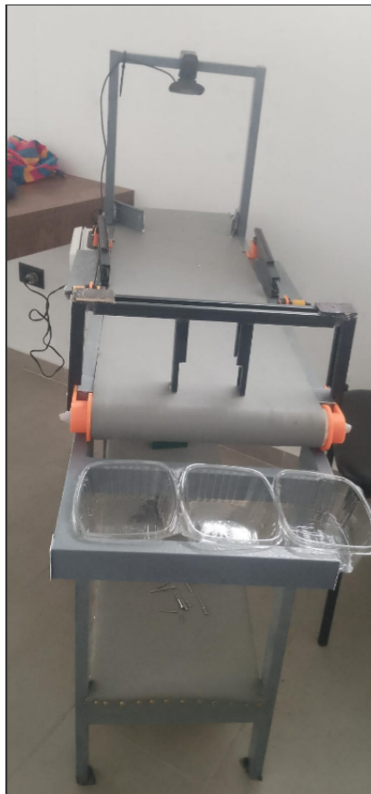
Anexo 9. Maquina de clasificación de camarón completa.
