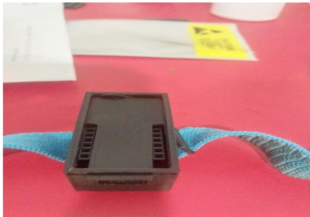
Ilustración 35: Pulsera de monitoreo de la prótesis IoT.
