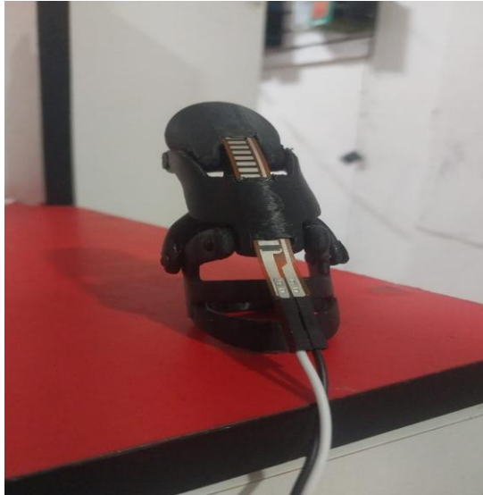
Ilustración 28: Montaje del sensor flex.
