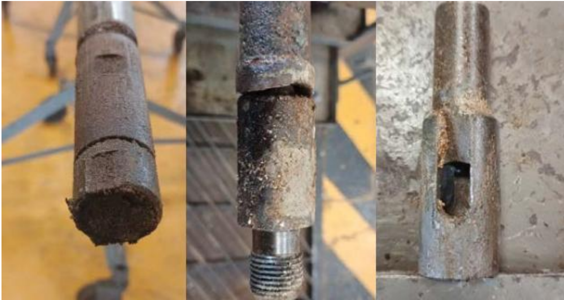
Figura 41 Recolección de muestra de parafina del pozo SPA0235
