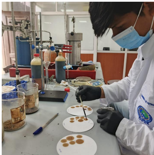
Figura 36 Prueba de la mancha en Laboratorio de Petróleos UPSE
