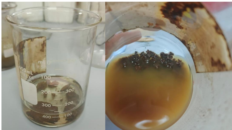
Figura 30 Comportamiento de la parafina del pozo ANC0024 durante la prueba de solvencia con CGN
