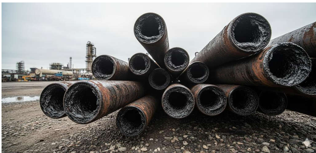
Figura 10 Tubería tapada con parafina
