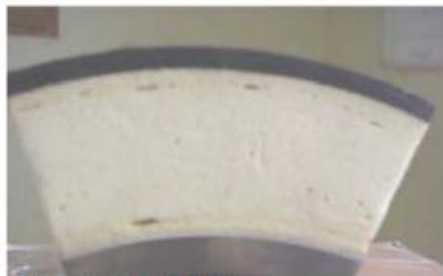
c) Revestimiento en línea de conducción
