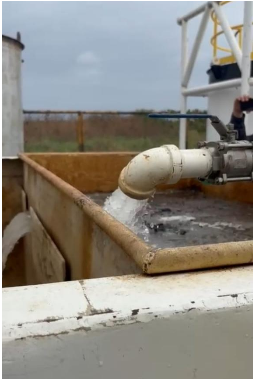
Figura 34 Desplazamiento con bache de agua fresca hacia el wash tank
