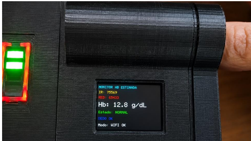
Figura 31. Visualización de las componentes ópticas IR y RED obtenidas por el sistema durante una medición
