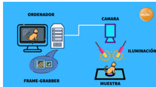
Figura 19: Elementos de un sistema de visión artificial [30].
