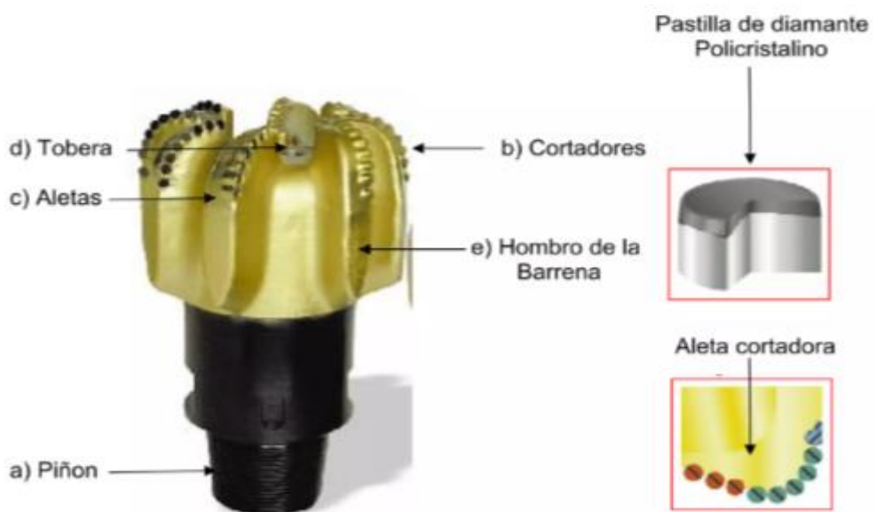
Figura. - 8. Broca PDC. Fuente: (Schlumberger)
