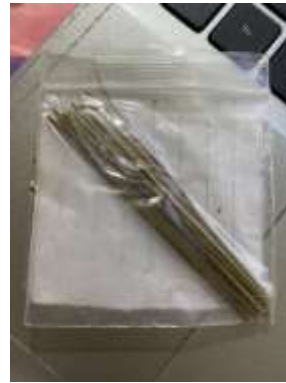
Ilustración 3 Fibra a 7cm con tratamiento de NaOH
