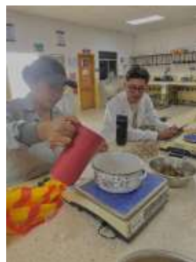
Ilustración 2 Tratamiento de la fibra con NaOH
