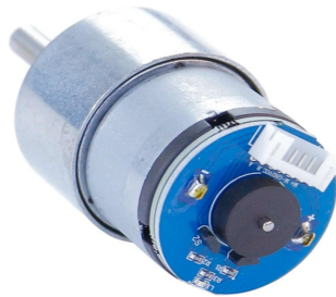
Figura 28: Motores 520 con codificador. [48].
