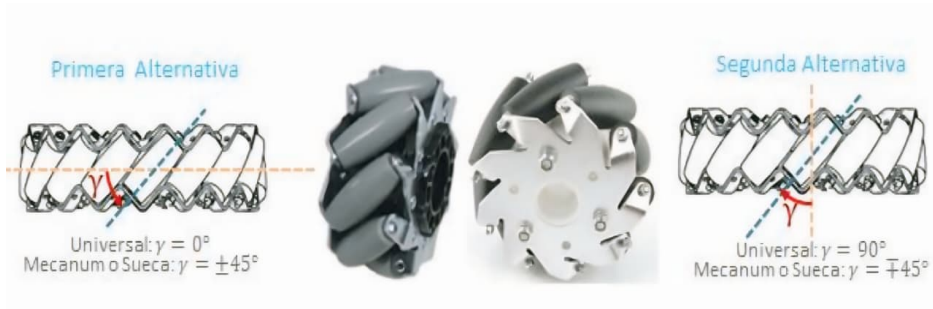
Figura 12: Rueda omnidireccional tipo mecanum o sueca [13].
