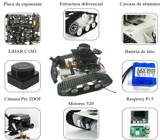
Figura 35: Esquema del robot Transbot [Fuente: Autor].
