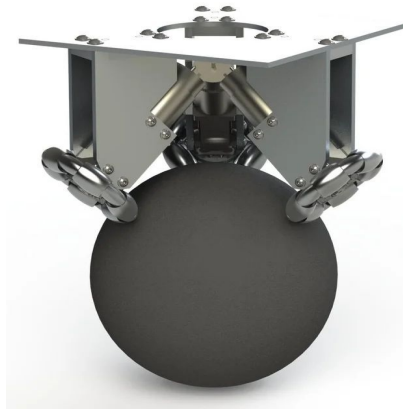
Figura 13: Arquitectura de rueda esférica motorizada por Kumagai y Ochiai [13].
